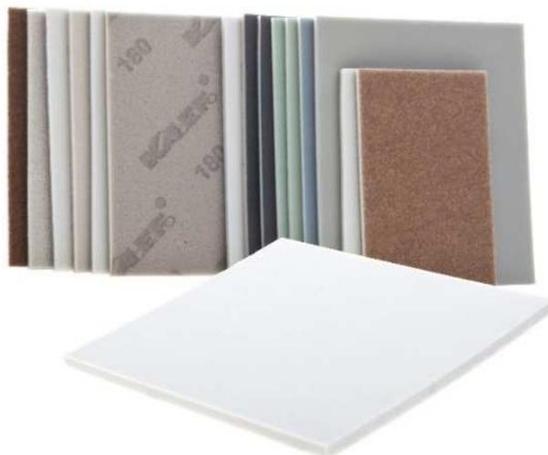
Durch den Einsatz von Schaumstoff als Trägermaterial unterscheiden sich gestreutes Korn und das erzielte Schliffbild. Wir geben daher an: Korn = gestreutes Korn und Schliffbild = entspricht ca. dem Ergebnis von Schleifpapier (z.B. Korn 100 = ca. P 220). Bitte prüfen Sie selbst. Ein, wenn auch geringer, Kornausbruch ist normal. Werkstücke sind nach der Bearbeitung zu reinigen.
